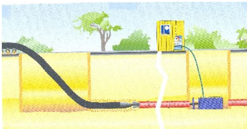
Slika 7.21 Šematski prikaz postupka "Berstlining" saniranja starog cjevovoda
